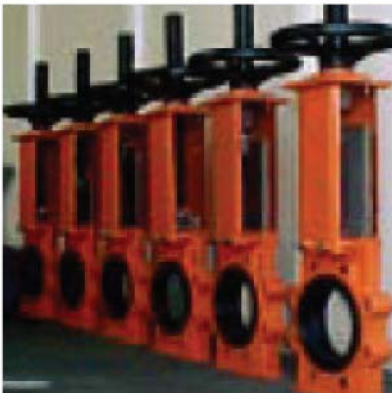
• 在南美工厂准备运往客户的 Isogate WS重型渣浆阀
