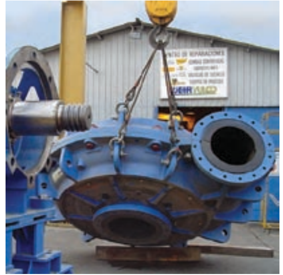
Вверху: инновационное устройство для быстрой замены проточных частей насосов МС. Снятие проточной части насоса 650 MCR в Сантьяго, Чили
