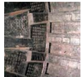
Arriba: Revestimiento con insertos de acero usado en proximidad de la parrilla del molino
