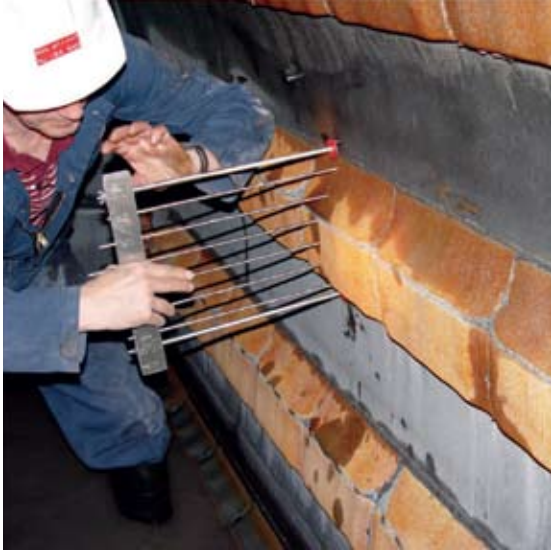
Arriba: Midiendo desgaste para predecir vida útil
