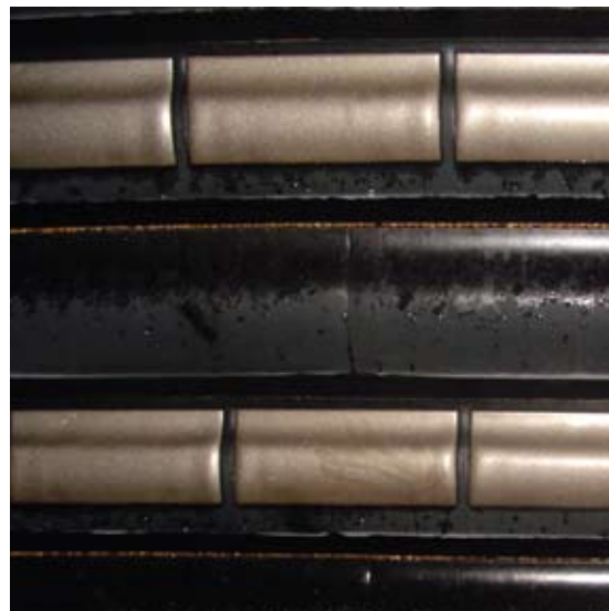
Arriba: Revestimiento con insertos de acero usado en proximidad de la parrilla del molino
