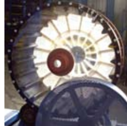
Izquierda: Modelo para diseño optimizado del conjunto de parrillas de descarga
