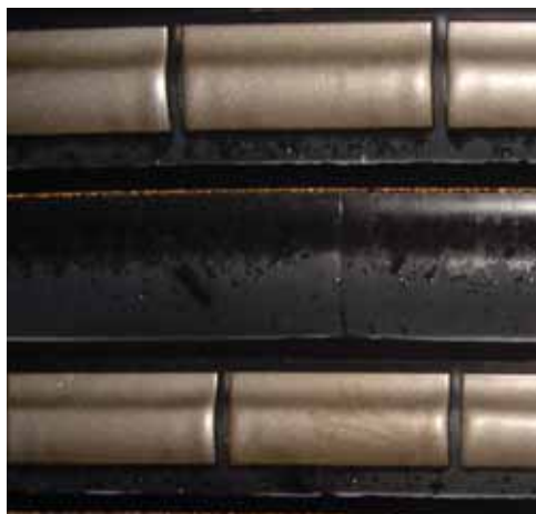
Acima: Revestimento com "cap" metálico na região próxima a grelha descarga.
