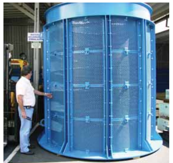
Abaixo: Trommel de Descarga revestidos de borracha, com telas metal/borracha. Desenvolvidos e projetados com análise de elementos finitos (FEA), garantem melhor performance operacional e baixos custos de manutenção.
