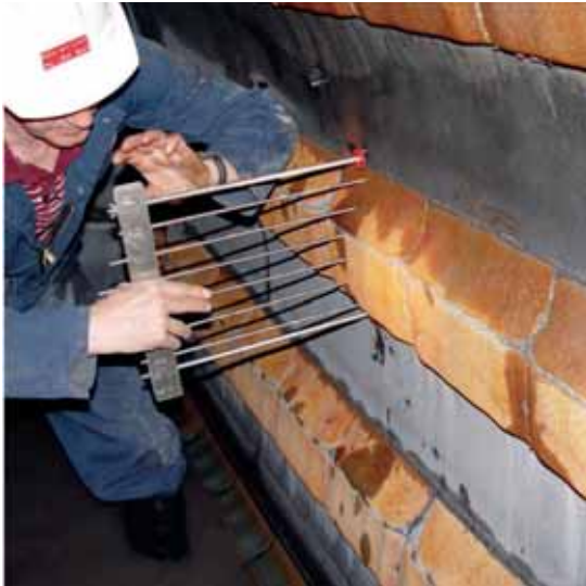
Acima: Controle e medição de desgaste para previsão de vida útil do revestimento.
