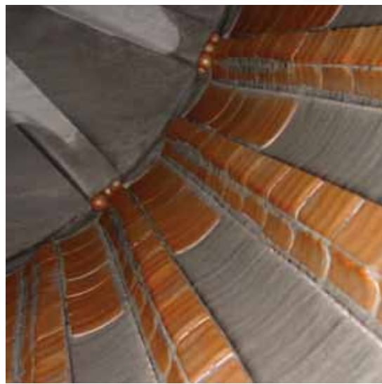
Acima: Placas com "Cap" metálico VULCO patenteado, aplicado em serviços pesados com corpos moedores de diâmetros elevados (moinhos tipos AG e SAG).
