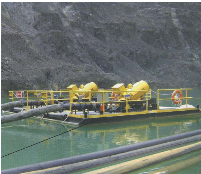
Широкий понтон с низким центром тяжести
