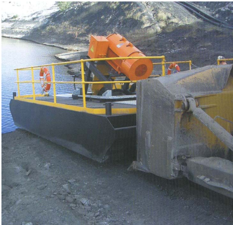
Вверху: использование бульдозера для спуска насосной установки на понтоне вниз по пандусу.
