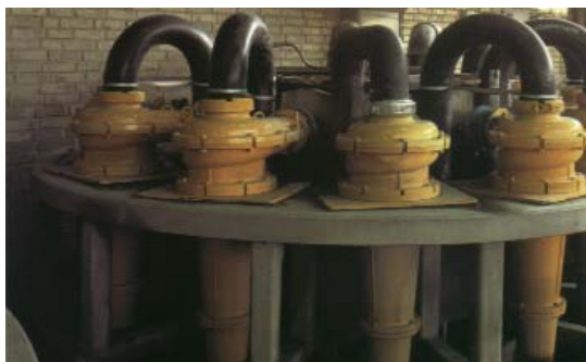
Une installation de cyclones CAVEX® dans une mine européenne de plomb et zinc en remplacement des cyclones conventionnels. Cette installation fait suite à un essai qui a démontré des gains notables tant en récupération qu'en durée de vie des blindages.
