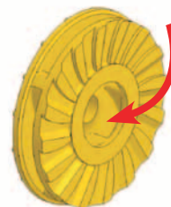
Ailettes frontales épaisses et profilées pour réduire la recirculation interne donc l'usure de l'impulseur et du flasque d'aspiration.
