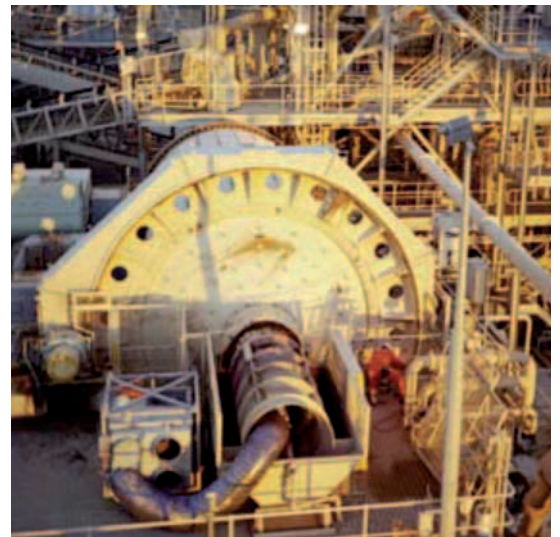
A gauche : marches d'accès et câble aérien pour la sécurité durant la maintenance.
