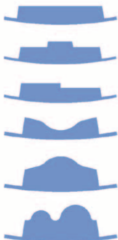
Ci-contre : différentes configurations de blindages, de haut en bas : SFL, SCL, SSL, SSW, SDW et STW.
