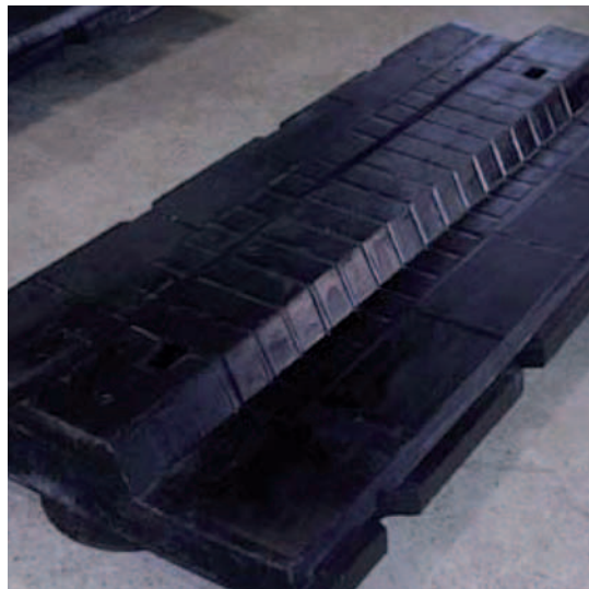
Ci-dessus : revêtement de virole SFL composite (métal/caoutchouc).
