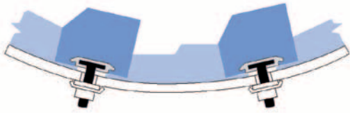
Ci-dessus : blindage typique Vulco avec releveur SIC/A et blindage SSL avec système de fixation.
