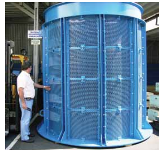
Abaixo: Trommel de Descarga revestidos de borracha, com telas metal/borracha. Desenvolvidos e projetados com análise de elementos finitos (FEA), garantem melhor performance operacional e baixos custos de manutenção.
