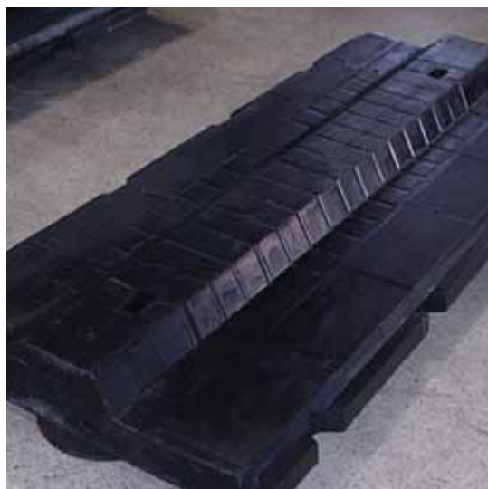
Acima: Revestimento de borracha tipo SFL com inserção de cap metálico.
