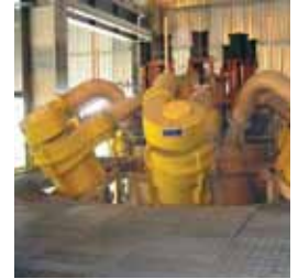
Bateria de ciclones 800CVX aplicados em mineração de cobre no Brasil.
