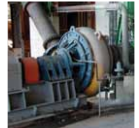
Bomba modelo MCU, para descarga de moinho em operação em planta de cobre no Brasil.
