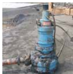
Bomba submersível em operação com finos de minério de ferro.
