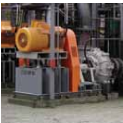
Bomba Horizontal Warman em operação no processo em planta de cobre no Brasil.
