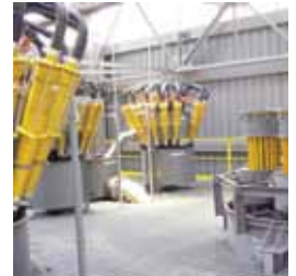
Bateria de ciclones 40CVX e 100CVX fabricados em poliuretano.
